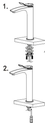
4. Reinstale a arruela de borracha seguida da arruela de metal e da contraporca. Aperte manualmente e depois aperte ainda mais usando uma chave de fenda para apertar os parafusos de contraporca.
