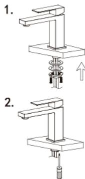
4. Reinstale a arruela de borracha seguida da arruela de metal e da contraporca. Aperte manualmente e depois aperte ainda mais usando uma chave de fenda para apertar os parafusos de contraporca.
