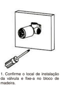
1. Confirme o local de instalação da válvula e fixe-a no bloco de madeira.
