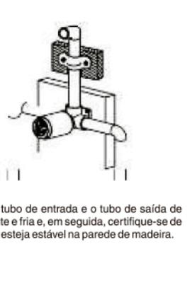
2. Ligue o tubo de entrada e o tubo de saída de água quente e fria e, em seguida, certifique-se de que o tubo esteja estável na parede de madeira.
