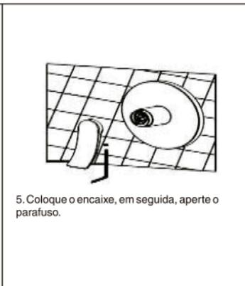
5. Coloque o encaixe, em seguida, aperte o parafuso.
