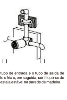
3. Faça um furo no azulejo de acordo com o tamanho e a forma da cobertura protegida (cerca de 5mm maior do que a cobertura protegida de cada lado). E, coloque o azulejo fora da parede de madeira (tenha atenção de manter o mesmo ponto central para o furo do azulejo com a tampa protegida).
