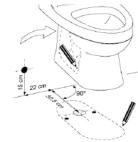
2. Verifique o alinhamento do vaso sanitário em relação à parede e marque os furos para fixação no chão (na parte traseira do vaso sanitário).
