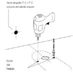
3. Remova o vaso sanitário para furar e instale os bujões de fixação EPEC-DH-BL para fixar o vaso sanitário ao chão:
